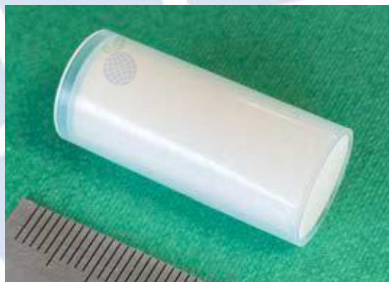
Figura 7.1 - Dispensador / difusor de atrativo constituído por tubo de plástico selado com tampão poroso permeável.
